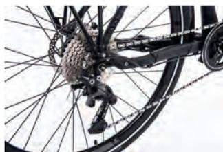
Kettenschaltung: für schnelle und präzise Gangwechsel.
