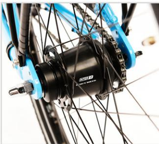
Frontlicht mit Standlicht, V-Bremsen, gute Reifen. Unten: Wartungsarm: 7-Gang-Nabenschaltung mit Rücktrittbremse.
