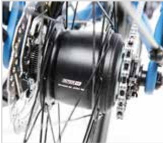
Große 180 mm-Bremsscheibe vorn für sicheres Stoppen. Unten: Nabengetriebe: sportives Schalten und wartungsarm zugleich.
