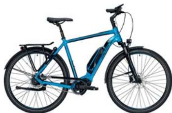
Das E 8.8 bietet seiner Fahrerin und seinem Fahrer nicht nur die elektrische Unterstützung durch einen Shimano STEPS E6100-Antrieb, sondern überträgt auch die Schaltbefehle vom Lenker zur 8-Gang-Nabenschaltung auf elektronischem Weg. Das macht zum einen die Bedienung sehr komfortabel, zum anderen sorgt es für besonders geschmeidige Schaltvorgänge, da Antrieb und Schaltung miteinander kommunizieren.
