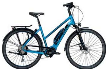
Dank kompaktem Shimano STEPS E8000-Motor ist der Durchstieg des Waverahmens besonders tief und komfortabel – und auch in den beiden weiteren Rahmenformen gefällt der Motor durch seine kleine Bauform. Der STEPS E8000 ist der kräftigste unter den Shimano-Antrieben, so ist beim E 8.9 für eine ordentliche Prise Dynamik gesorgt.
