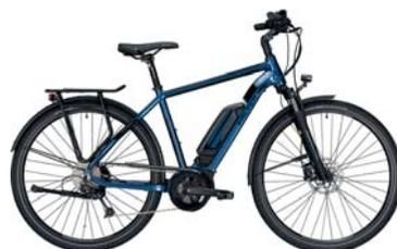
Die elektrische Unterstützung kommt beim E 9.0 RD von einem sanften Bosch Active Line-Antrieb, wobei zwei semiintegrierte Akku-Varianten zur Wahl stehen, die sich form-schön in die Silhouette des Bikes fügen: 400 Wh oder – noch ausdauernder: 500 Wh.
